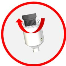
Drehen Sie die Cartridge nun in den Kopf der Elektrode ein.
