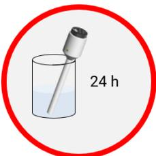
Stellen Sie HydroFlex für 24 Stunden in destilliertes Wasser. Der Schaft sollte dabei bis zur Hälfte in Wasser stehen.
