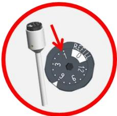
Oben am Elektrodenkopf drehen Sie mit dem Laufzeitschlüssel oder einem 3 mm Sechskantschlüssel die Laufzeit im Uhrzeigersinn auf Stellung 1, das entspricht 1 Monat.
