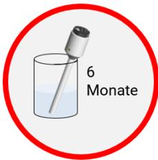
Sobald die Laufzeit von 6 Monaten erreicht wird, muss umgehend die Wasserstoffcartridge ausgetauscht werden (siehe 4. Wartung). Andernfalls bildet sich ein Unterdruck in der Elektrode, so dass Flüssigkeit in das Innere der Elektrode gelangen kann.
